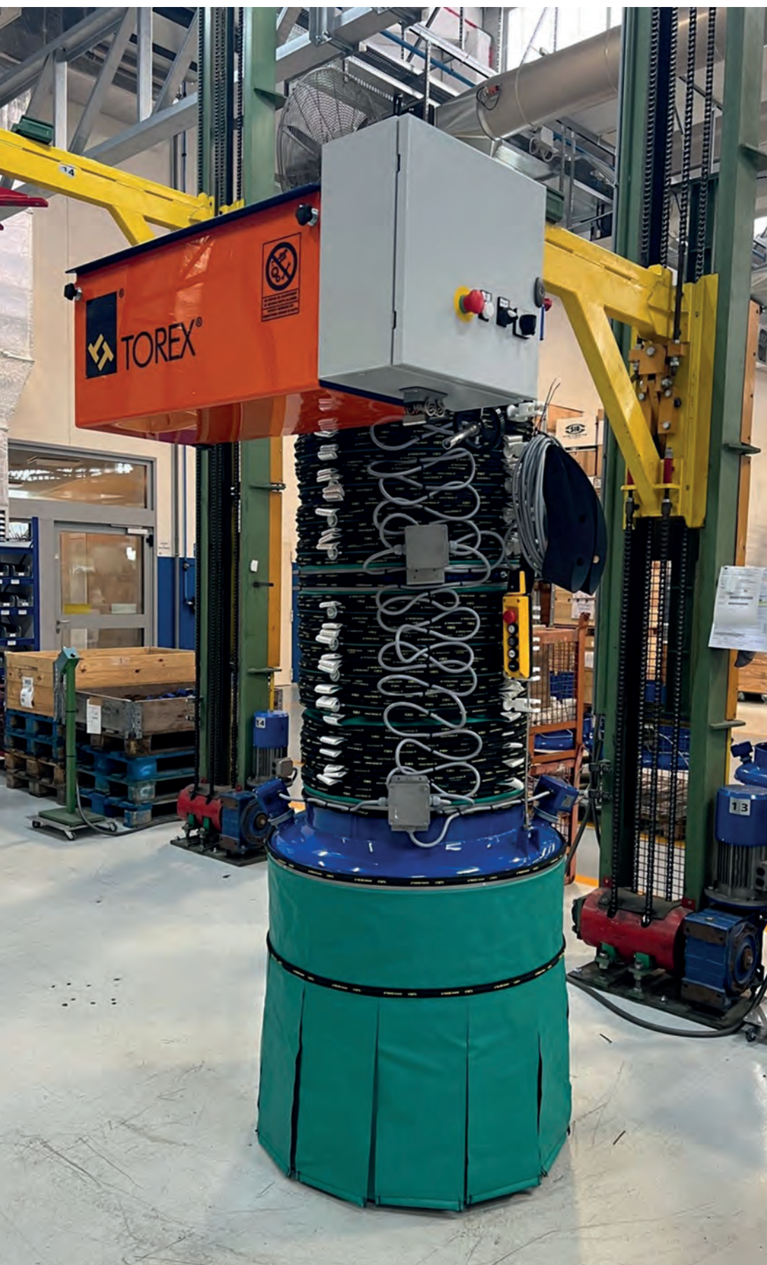
De productie van beladingsbalgen voor project Azië 2023 – zoals deze ZK- en ZX-combinatie voor de belading van graan in een open vrachtwagen – gebeurt met behulp van verstelbare hijsmachines.
