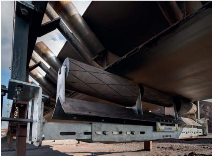
Afb. 2 De CenTrax Belt Tracker voorkomt scheefloop
