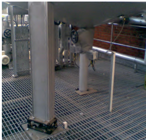
Afb. 2 Een tankweging met een Model Mastermount loadcell.
