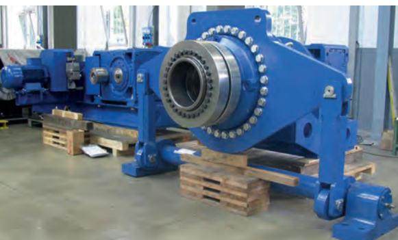
Afb. 4 Rossi gecombineerde aandrijving met een speciale reactiearm.
