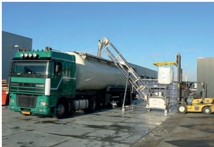
Afb. 3 Ompakken van een big bag in een bulkwagen met behulp van een Floveyor.
