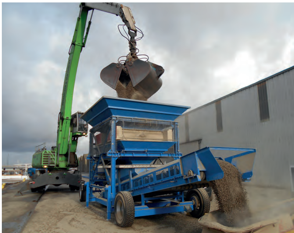
Afb. 1 Een Bascules Robbe mobiele doorstroomweger wordt beladen door een overslagmachine.
