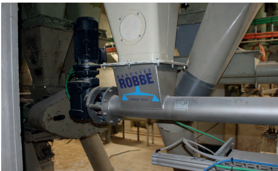
Afb. 4 Bascules Robbe levert ook transportschroeven en aanverwante apparatuur om producten nauwkeurig in processen te doseren.
