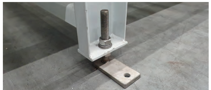
Afb. 5 Roestvaststalen stelpoten van een rollenbaan.
