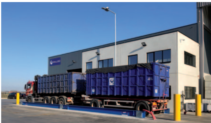
Afb. 2 Alle verkeer over de weegbrug wordt geregistreerd in software van Bascules Robbe, gekoppeld aan bovenliggende systemen
