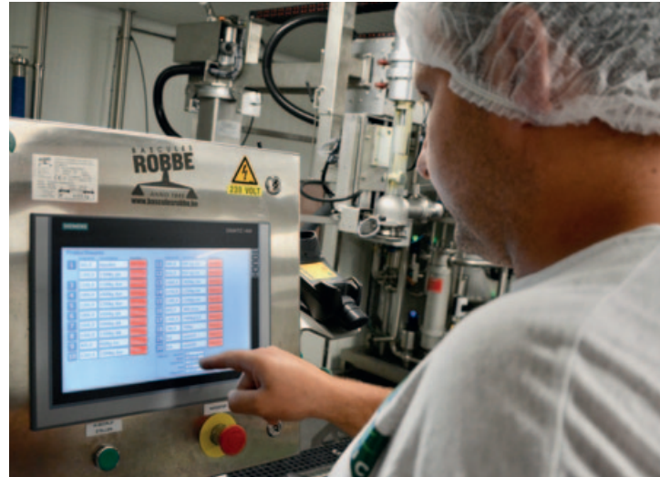
Afb. 3 Het vulproces kan op een touch screen worden bediend
