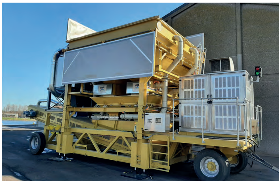
Afb. 3 Een mobiele doorstroomweger
