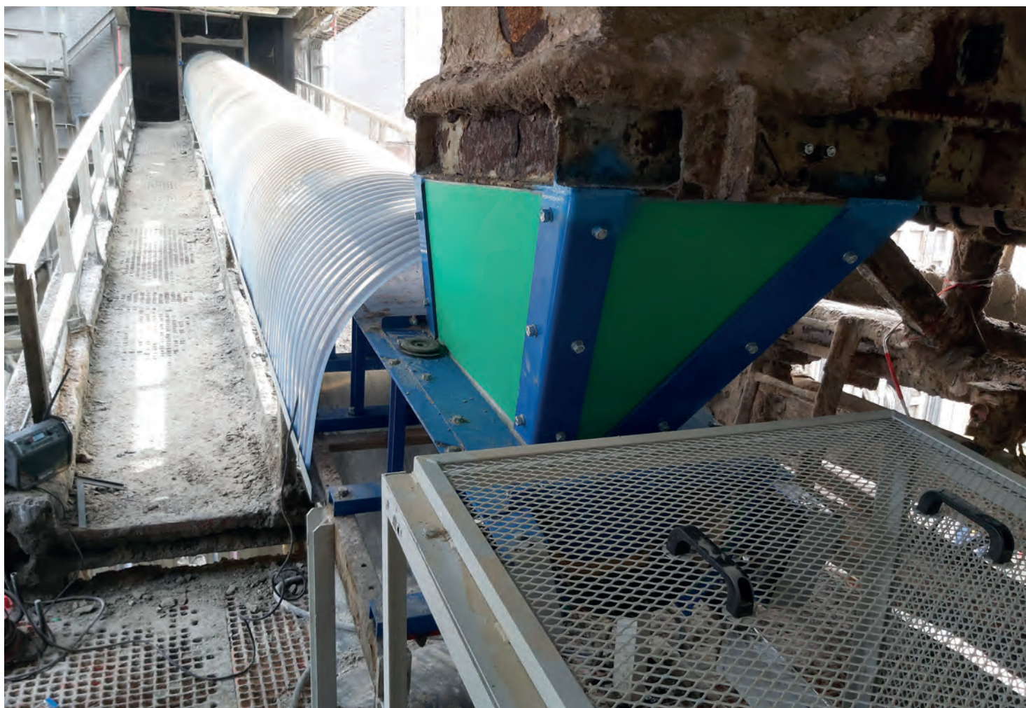
Afb. 1 De Promati Proload bandoverstort voorkomt mors
